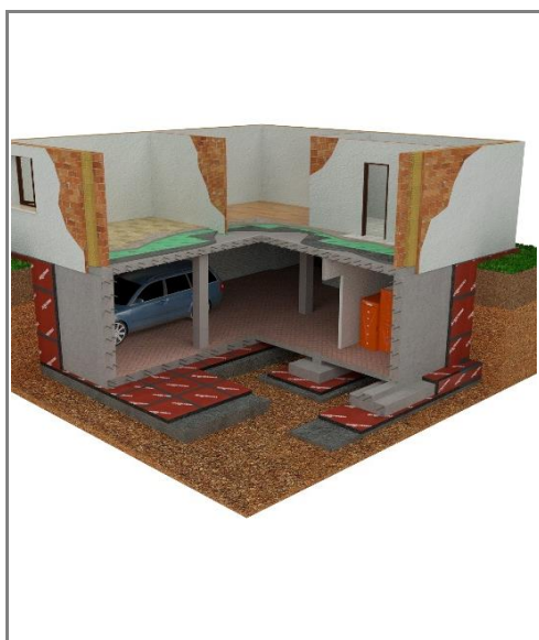
WIBROIZOLACJA FUNDAMENTÓW BUDYNKU
