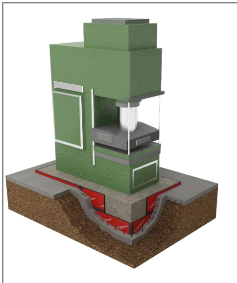
ISOLATION DE MACHINES SUR FONDATION FLOTTANTE
