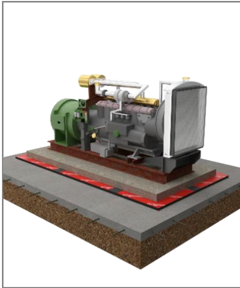
ISOLATION DE DALLES FLOTTANTES POUR MACHINES-OUTILS
