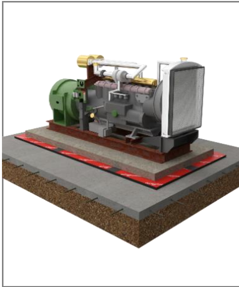
ISOLIERUNG VON SCHWIMMENDEN PLATTEN FÜR MASCHINEN
